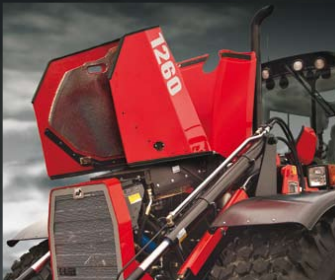
Motorhuvn är tredelad vilket underlättar åtkomst till motorn.
