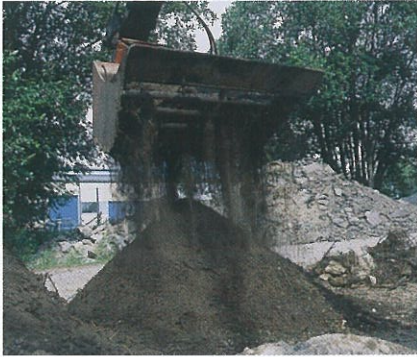
Bilden visar Huddig I 160 med gallringsskopa.
