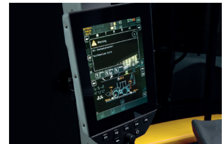
RCI varnar och bromsar in grävaggregatet vid tippningsrisk.
