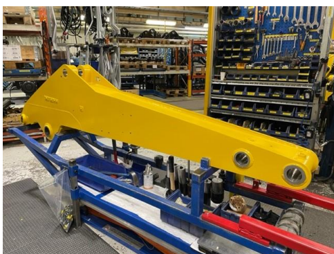
Bild 1. Omonterad grävarm placerad på fixtur. Foto: Marie Fall Selin
