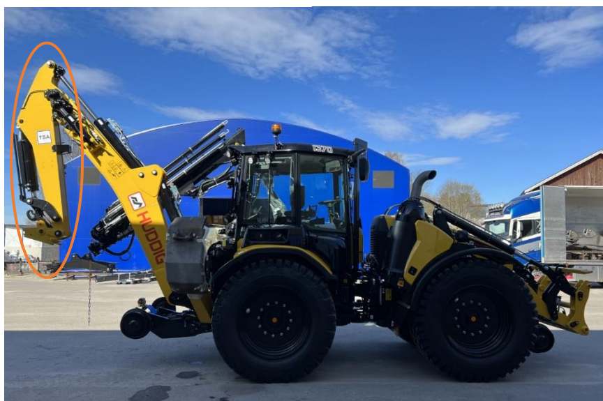
Bild 3. Färdigmonterad grävlastare med aktuell grävarm, se orange markering. Foto: Marie Fall Selin
