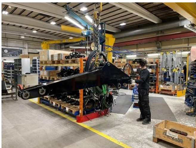
Förflyttning av grävarm med stortravers för placering i fixtur (monteringsställning). Foto: Marie Fall Selin
