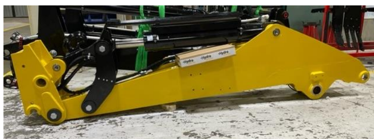
Bild 2. Monterad grävarm placerad på golv. Foto: Marie Fall Selin
